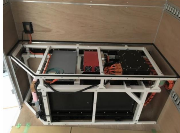
二次電池・ジャンクションボックス・DC/ACコンバータ・普通充電器
