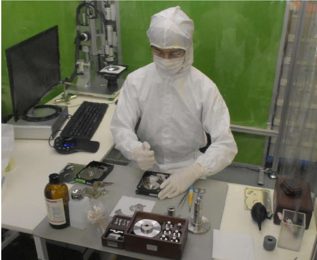
クリーンブースでヘッド交換をしている様子
