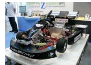
試作したFlexRay対応の電動カート
